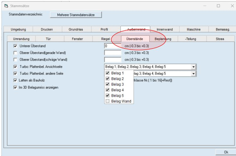
Unter dem Register Außenwand -> Überstände werden die Beläge für die Platten-Automatik eingeschaltet.
